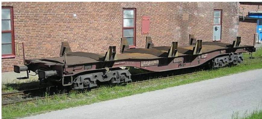
Foto 4: Den vanligaste typen godsvagn för transport av slabs har littera Sgmmnps 013 och är normalt försedd med bromsblock av gjutjärn
