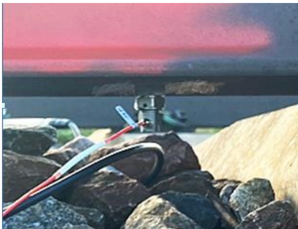
Foto 2: Accelerometer och mekaniskt filter monterad med neodymmagnet under rälfot
