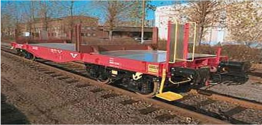
Foto 5: Denna godsvagn för transport av slabs har littera Sgmmnps 960 och är normalt försedd med bromsblock av kompositmaterial
